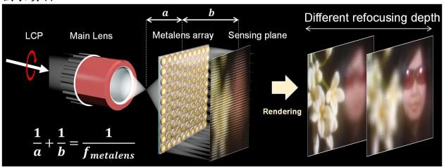
圖一 利用氮化鎵消色差超穎透鏡陣列收集光場資訊,可重建不同聚焦深度之 影像。
