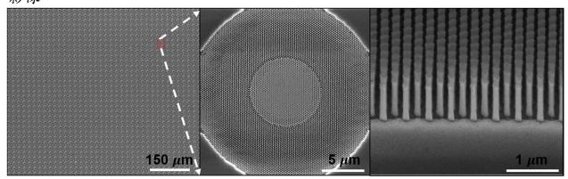
圖二 寬頻消色差超穎透鏡陣列之電子顯微鏡照片。
